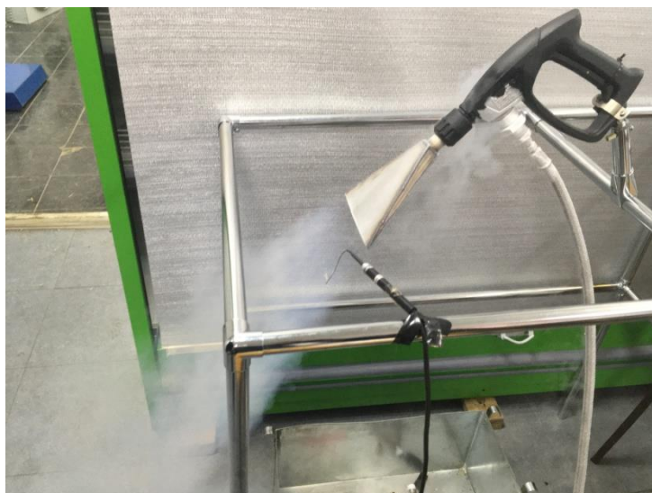
Рис. 3 Работа устройства типа «пистолет» с насадкой раструб при работе с газообразным азотом.
