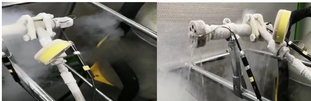
Рис.6. показан общий вид холодной (а) и условно “горячей” (б) стороны вихревой трубы с факелом распыла газообразного азота.
