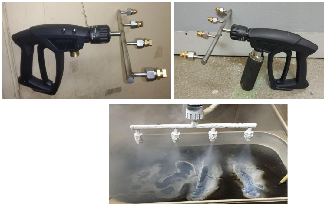
Рис. 1 Криогенное распылительное устройство типа «пистолет».
