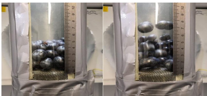
Рис.4. Высота насыпного слоя черника (а) и высота в процессе (б) флюидизации.
