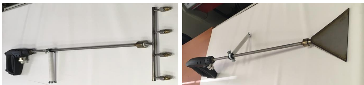
Рис. 3 Азотное распылительное устройство типа «пистолет» с удлинителем и насадками в виде коллектора с 4-мя форсунками(слева) и раструбом(справа).
